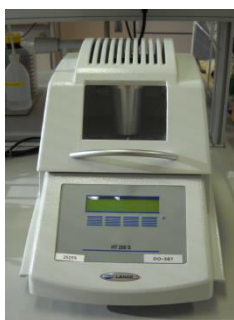
Slika 4: Aparatura za pripravo vzorca za analizo na spektrofotometru HACH.
