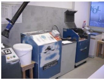
Mletje premoga, petrol koksa v laboratorijskem mlinu Herzog
