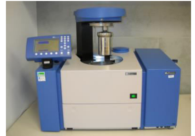
Kalorično vrednost goriv določamo v kalorimetru IKA C 5000 pri konstantnem volumnu in oksidativni atmosferi
