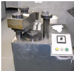
Priprava tablete iz zmetega goriva na stiskalnici Herzog
