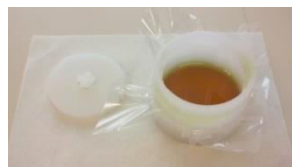
Za analize odpadnih olj in kostne moke uporabimo OMNI celice
