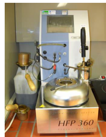
Aparat za določevanje plamenišča Herzog HFT 360 - določa plamenišča tekočin od 40 do 250° C
