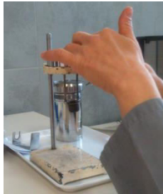
Priprava posode za razklop: nameščanje briketa v zgorevalni lonček
