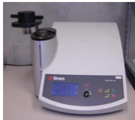
S pomočjo stiskalnice CitoPress-10 (Struers) (temperatura 180 °C in tlak 300 bar) iz 2D goriva izdelamo tablete
