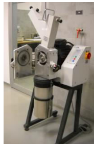
Mletje 2D goriva v laboratorijskem mlinu Retsch SM 2000 (rezalni mlin)
