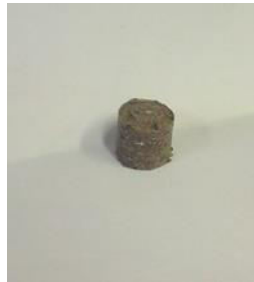
Briket iz 2D goriva pripravljen na sežig
