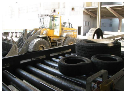
Slika 4: Strojno nalaganje odpadnih gum na transportni trak.
