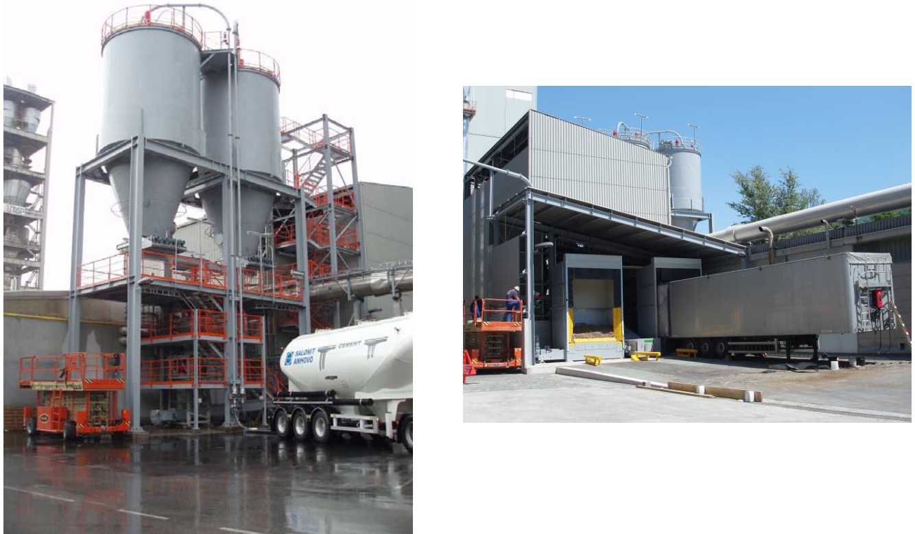
Slika 5: Naprave za skladiščenje in doziranje trdih alternativnih goriv na gorilnik peči
